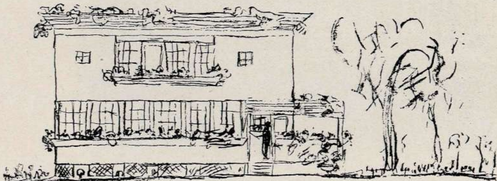
Maison « Domino ». Logement et échoppe. Pas de murs portants ; les fenêtres font le tour de la maison.
